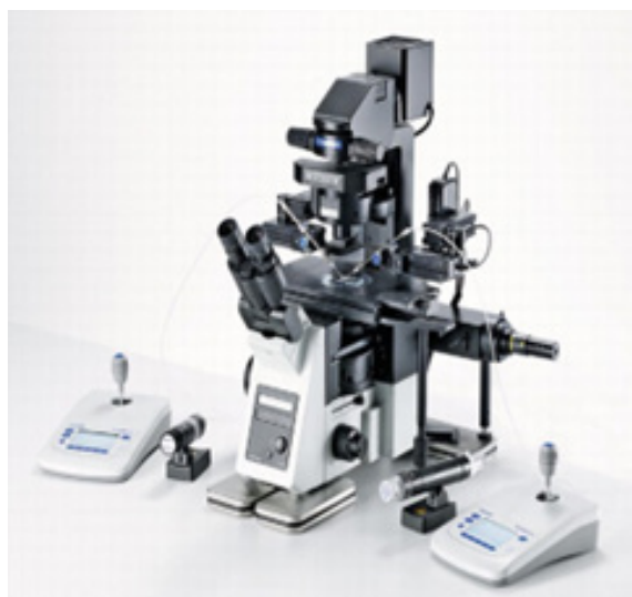
चित्र 2 - ईएएफ में स्थापित उलटे माइक्रोस्कोप के साथ माइक्रोमैनिपुलेटर माइक्रोइंजेक्टर
